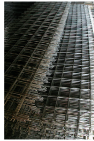
Gitter (Metall-, geschweißt, ver- stärkend, für Mauerwerk)
