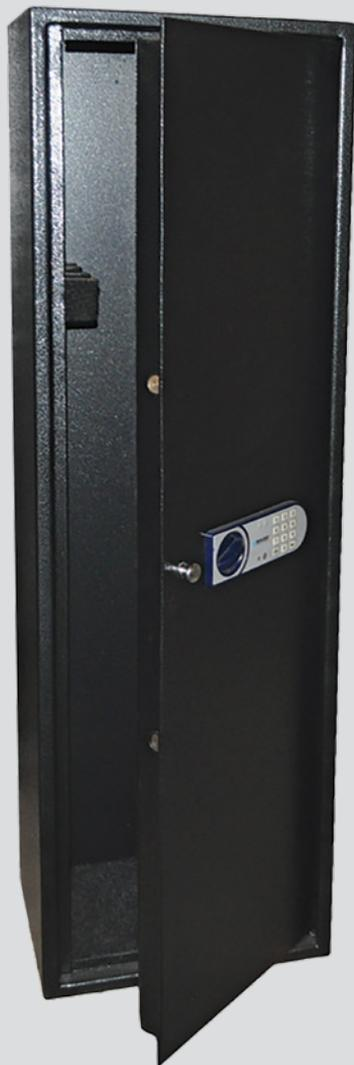
*Корпус* – цельнометаллическая сварная конструкция из горячекатаного листа толщиной 3 мм, оснащена элементами крепления в нижней стенке.
